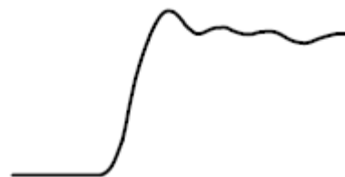
Длинный провод заземления
